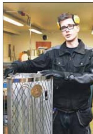
Kiuukaiden turvaetäisyys on vain 10 senttiä. Kiuukaan ympärillä oleva verkko ei kuumennu saunaa lämmittäessä niin paljon, että ihonkosketuksesta syntyy palovammoja.
