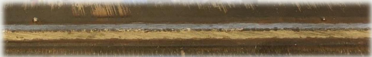
S=8mm, I=195A, V=29V, P=8kW ja v=1980mm/min
